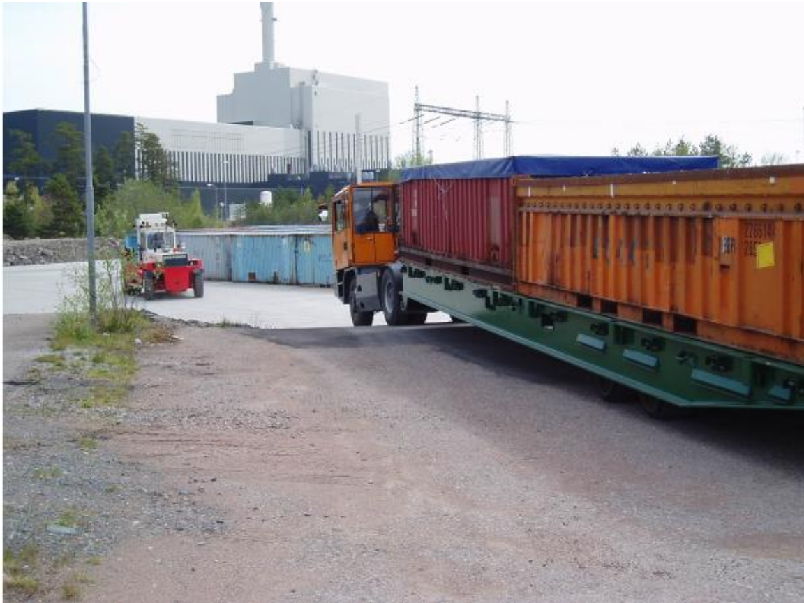
Figur 6: Transport av avfall från mellanlager till markförvar. Foto från tidigare deponeringskampanj vid MLA2, OKG 2004.
