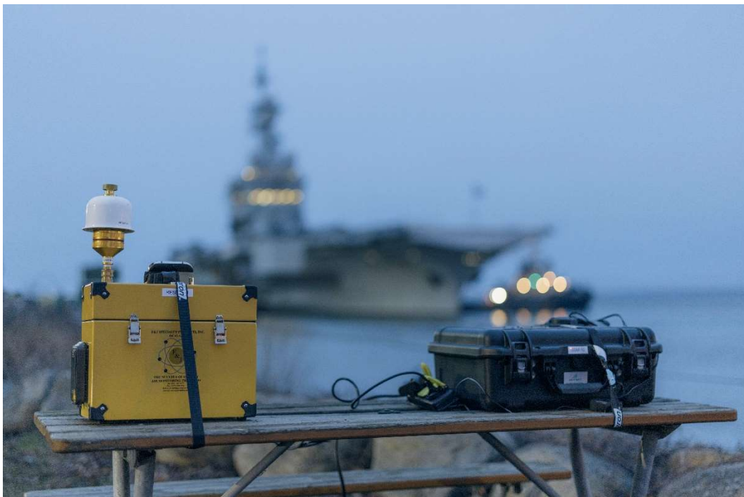
Figur 2. Luftfilterprovtagare till vänster och gammadosratmätare till höger installerade på punkt B. Gammadosratmätaren försågs efter installation med skyddande plastöverdrag. Foto: Hanna Wängemar, Försvarsmakten.
