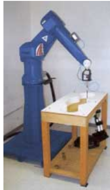
Figur 2: Mätuppställning för mätning av SAR-värdet med robot, mätsond, fantom och hållare för telefon.
