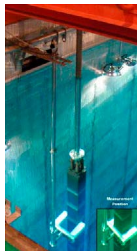
Figur 3. Bild på Forkdetektorn som mäter ett använt kärnbränsle i en vattenbassäng.
