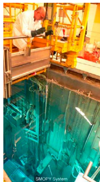
Figur 4. Bild på SMOPY-detektorn under vatten. Den högra bilden kommer från (LeBrun, 2009)
