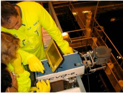
Figur 5. Bild på DCVDn som är fäst på räcket ovanför bränslebassängen.
