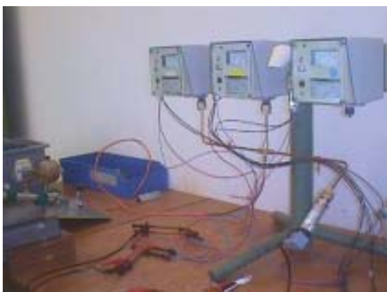
Figur 8.3 Laboratorietest av tre tryckgivare vid KKM.
