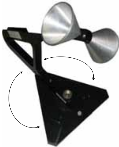
Figur 5.1: Mätantennen vreds till tre olika lägen för att mäta signaler från alla riktningar
