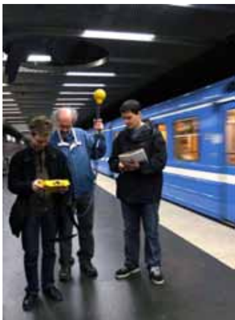
Figur 6.22: Mätningar med mätprob och spektrumanalysator på perrongen i en tunnelbanestation.
