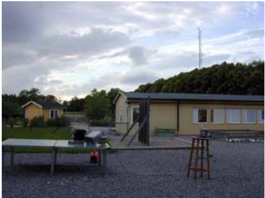
Figur 5.2: Mätuppställningen visar det 1,3 m höga trästativet med antennen. Till vänster syns spektrum-analysatorn och en bensindriven elgenerator.
