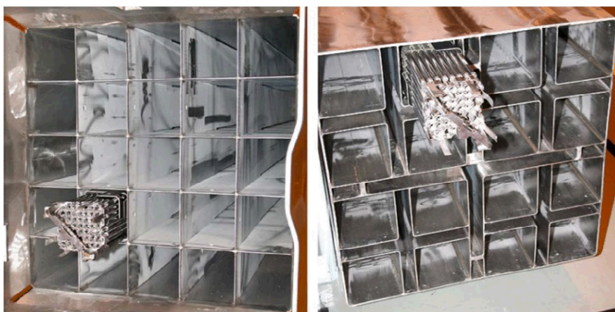
Figur 3-1. Fotografier på kompakt- respektive normalkassett för lagring av BWR-bränsle. Kompaktkassetter innehåller borlegerat stål.
