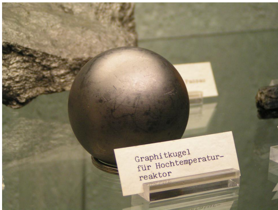
Figure 5: Kulformat bränsleelement för användning i HTGR-reaktorer.
