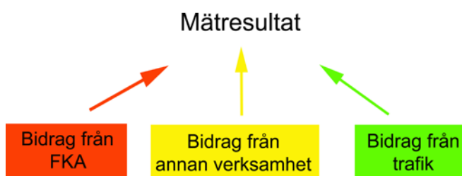
Figur 10-1. Illustration av sammansättningen av ljudet vid mätning långt ifrån kärnkraftverket i Forsmark.
