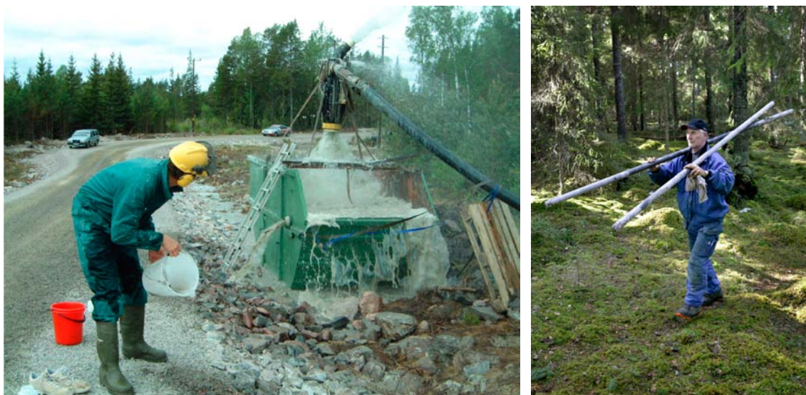
Figur 4-4. Två bilder som illustrerar två viktiga hydrogeologiska berggenskaper i Forsmark. Bilden till vänster: Höga borrhålskapaciteter har observerats i de övre delarna av berget. Bilden till höger: Många obrutna borrhärlor har hämtats upp ur det djupa berget i samband med kärnborrningarna.
