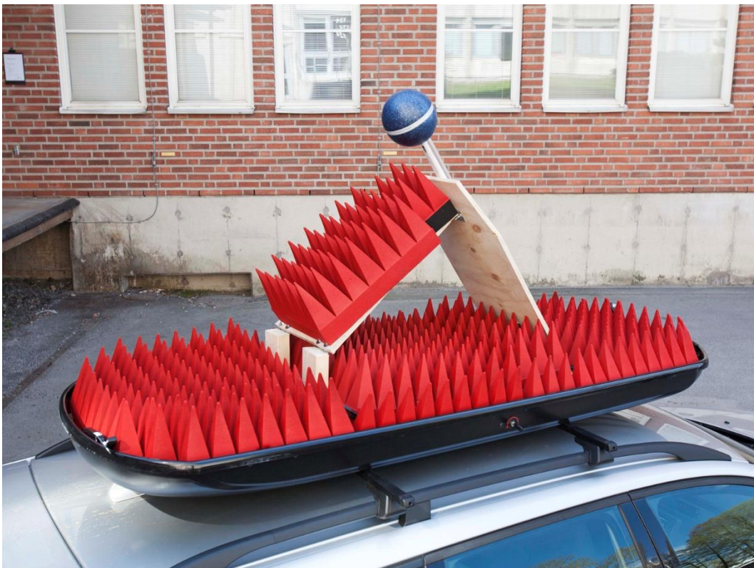
Figur 8. Takboxen med absorbenter och mätantenn placerad på bilens tak.
