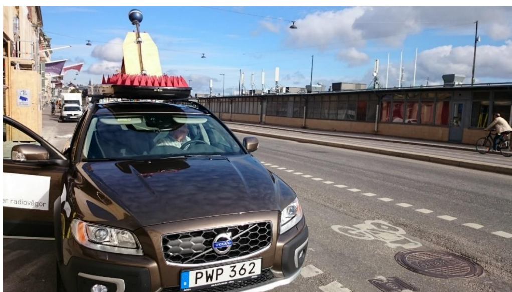
Figur 21. Mätning av radiovågor i stadsmiljö (vid Skeppsbron i Stockholm).
