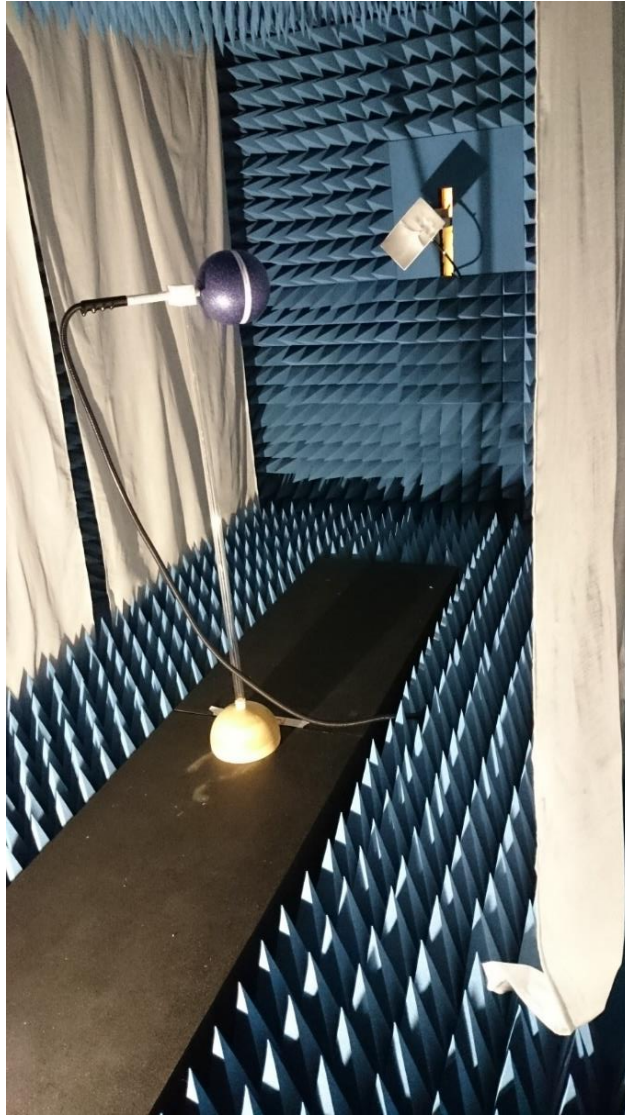
Figur 18. Mätantenn placerad framför den sändande hornantennen. Svarta gångabsorbenter på golvet och vita gardiner framför väggarna för att göra rummet ljusare. För att minimera felkällor från radiovågsreflexer undviks all onödig metall i rummet. Ljusprojektorer sitter på taket och ljuset leds in i rummet med glasfiber.
