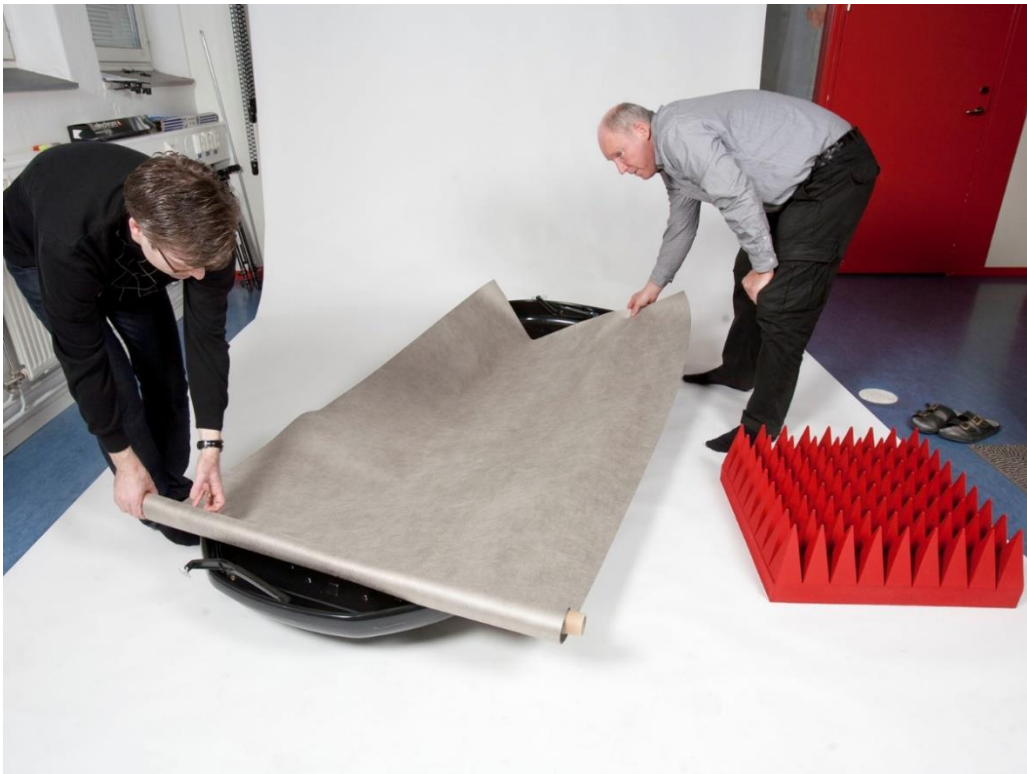
Figur 6. Den metallduk som läggs i botten utgör anpassning för absorbenterna och skärmar dessutom mot radiovågor från fordonets kommunikationsantennor.
