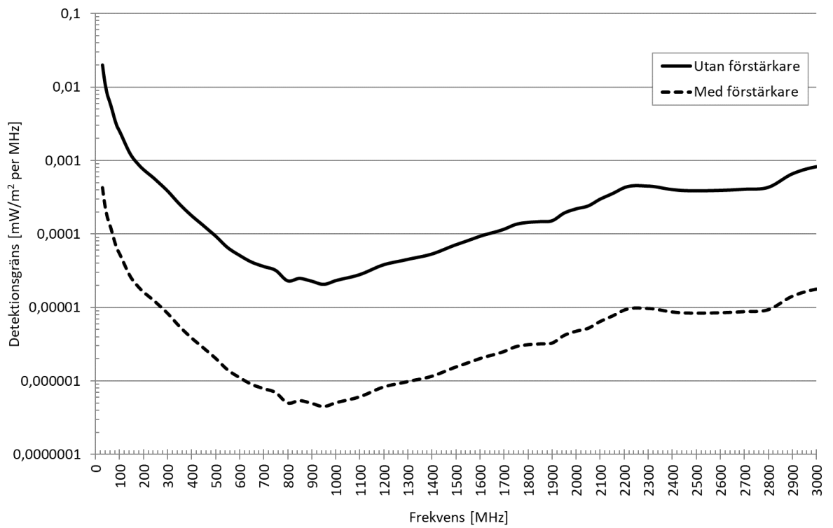
Figur 4. Mätssystemets detektionsgräns för olika frekvenser.
