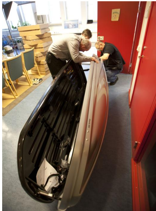
Figur 5. Takboxen modifieras för att kunna bära mätantennen.
