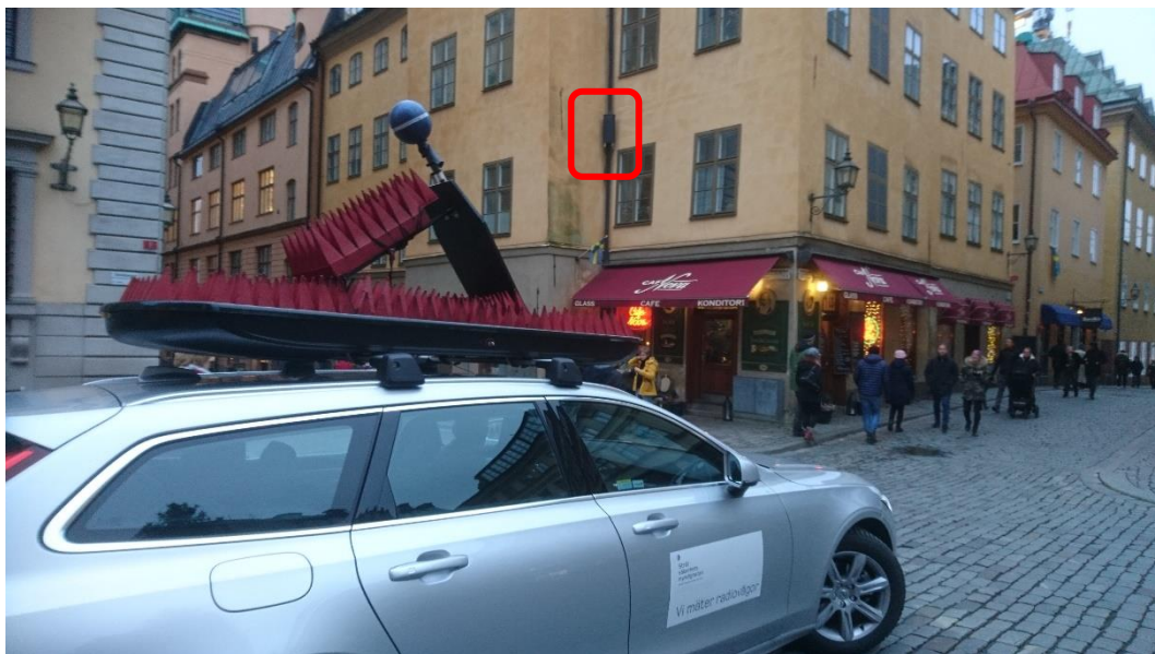
Figur 28. Basstationsantennen var placerad på stupröret i den röda markeringen på bilden. Exponeringen från andra radiovågskällor var försumbar. Mätantennen var ca 14 grader nedanför basstationsantennen och avståndet mellan antennerna var 16,5 m.
