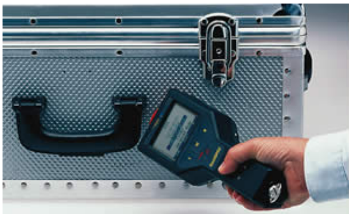
Figur 3: Det handburna instrumentet FieldSPEC som användes för isotopidentifikation i studien.
