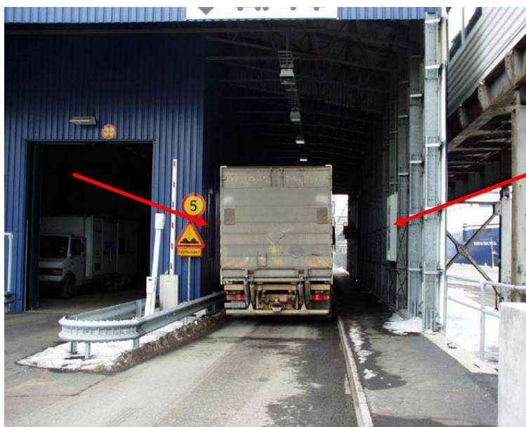
Figur 5. Portalmonitorns placering i lastbilsfilen i Stockholms frihamn. Pilarna markerar läget för de två detektorerna.
