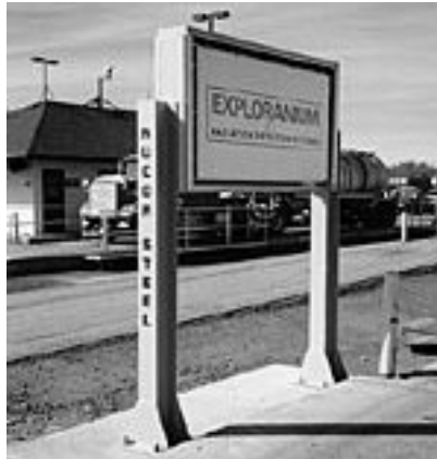
Figur 6: Exempel på en fast detektor som används för kontroll av lastbilar och tåg.
