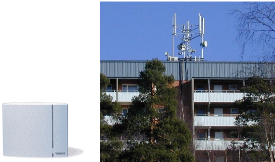
Figur 9. Basstation för DECT-systemet (till vänster) och basstationsantennerna för GSM utomhus (till höger).
