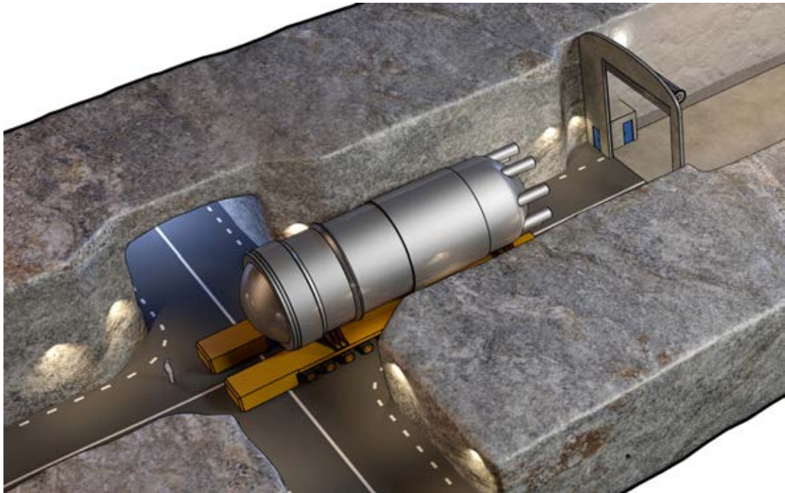
Figur 7-12. Illustration av två fordon av typen SPMT som kopplats ihop.
