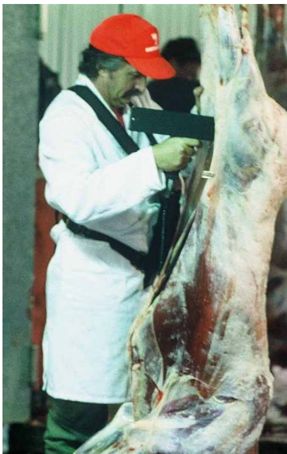
Bild 3. Externmätning av renslaktkropp för kontroll av ^{137}\text{Cs} . Monitoring gamma radiation on a reindeer carcass at slaughter to control the level of ^{137}\text{Cs} .
