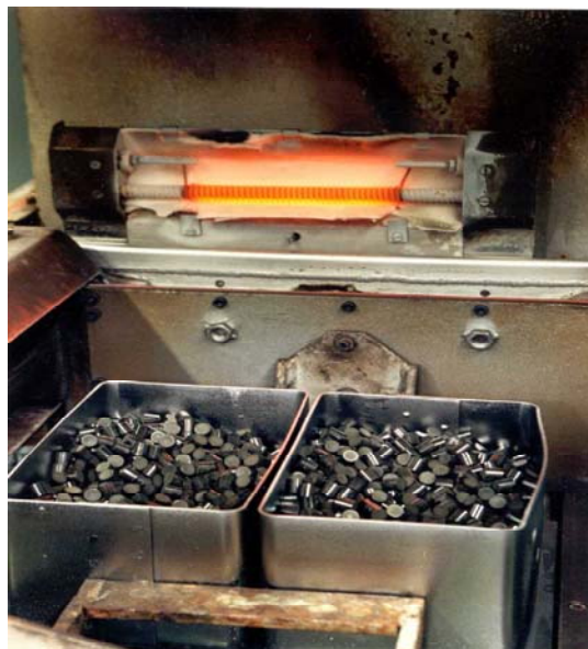
Figur 3. Kutsar av urandioxid för användning som bränsle i kärnreaktorer. Kutsarna packas i stavar och stavarna i sin tur i större knippen.
