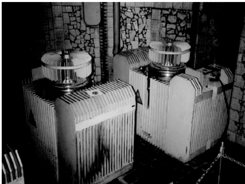
Sr-90-innehållande generator (RTG) av rysk konstruktion. Bild: IAEA
