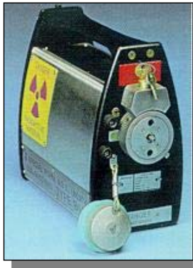
Figur 1. Radiograferingsutrustning innehållande 3 TBq Ir-192. Vid drift kopplas en mätprob till utrustningen där strålkällan kan föras ut för användning.
